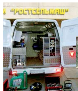
Передвижная мастерская для обслуживания сельскохозяйственной, дорожно-строительной и коммунальной техники. Электроагрегат АСПТ 200 - 6/230ВЛС.
