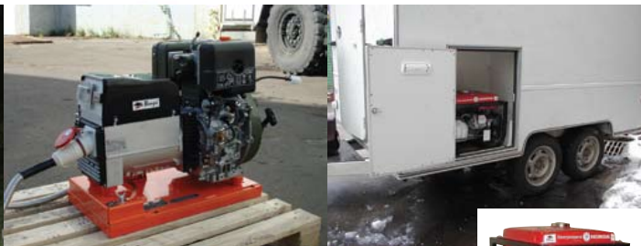
Электроагрегат АДП4,2-230ВЛ-С для поддержания температуры воды в системе охлаждения неработающего двигателя локомотива в заданных пределах
