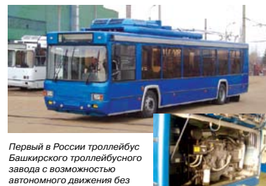
Установка электроагрегата АДС (двигатель DEUTZ + генератор SINCR0) Р-120кВт, напряжение 650 В постоянного тока на троллейбусе.
